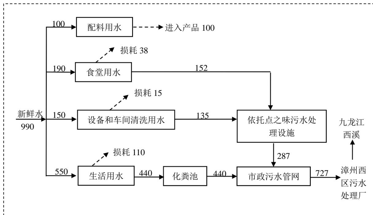
图 2-2 项目用排水平衡图 (单位: t/a)
