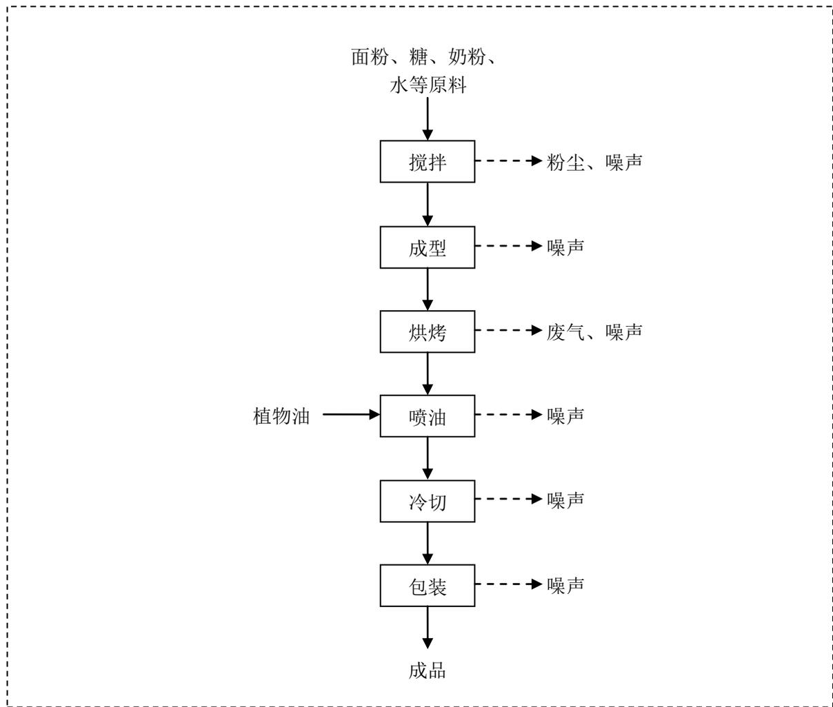
图2-3 项目生产工艺流程及产污环节
